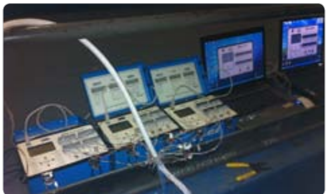
Obr. 10 Tenzometrické aparatúry ako súčasť meracieho reťazca
