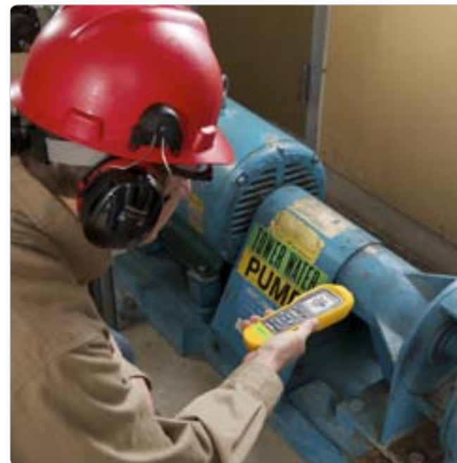
Obr. 3 Meranie stupňa vibrácií vodného čerpadla pre kontrolu jeho valivých súčastí.
